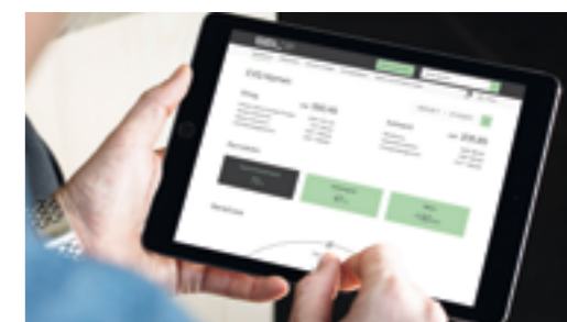
▲ Ein Blick aufs Display genügt: Grün steht für ausreichend günstiger Solarstrom vorhanden, Rot für teureren Netzstrom.
